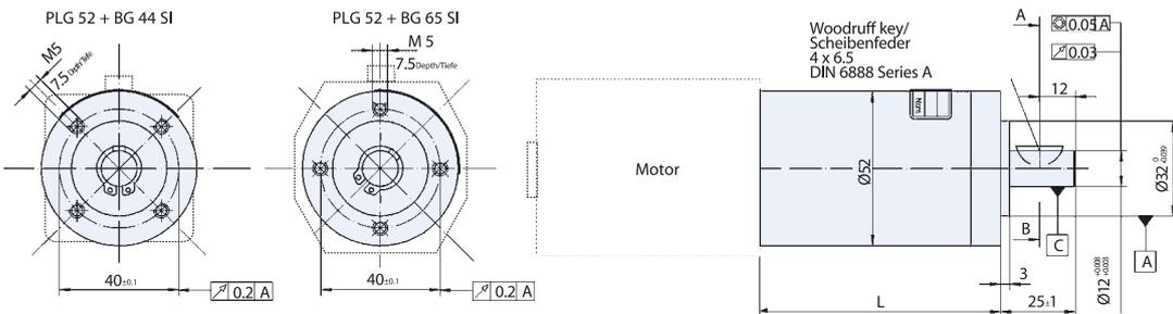
Редуктор для электродвигателя GR42, GR51, GR53, GR63, BG42, BG44, BG45 и BG65.
